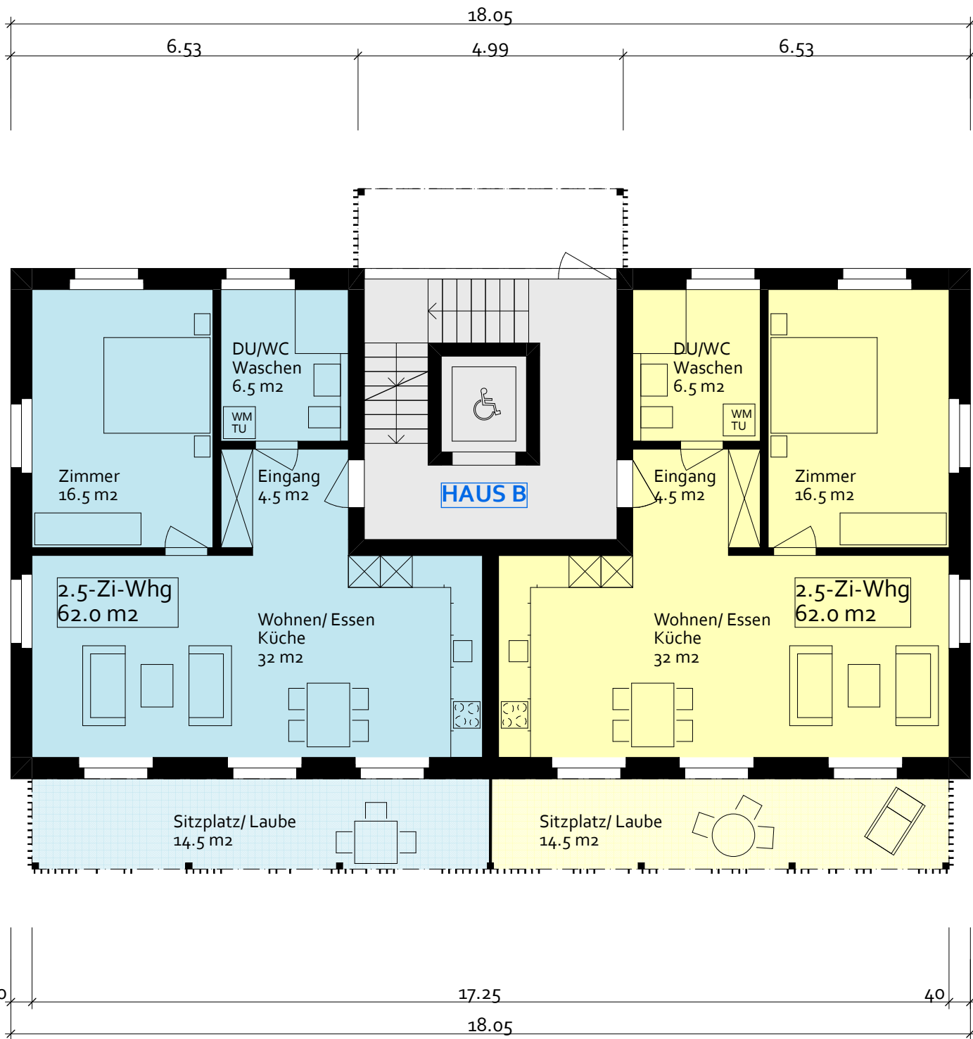
Grundriss Erd- Ober- und Dachgeschoss, Haus B
