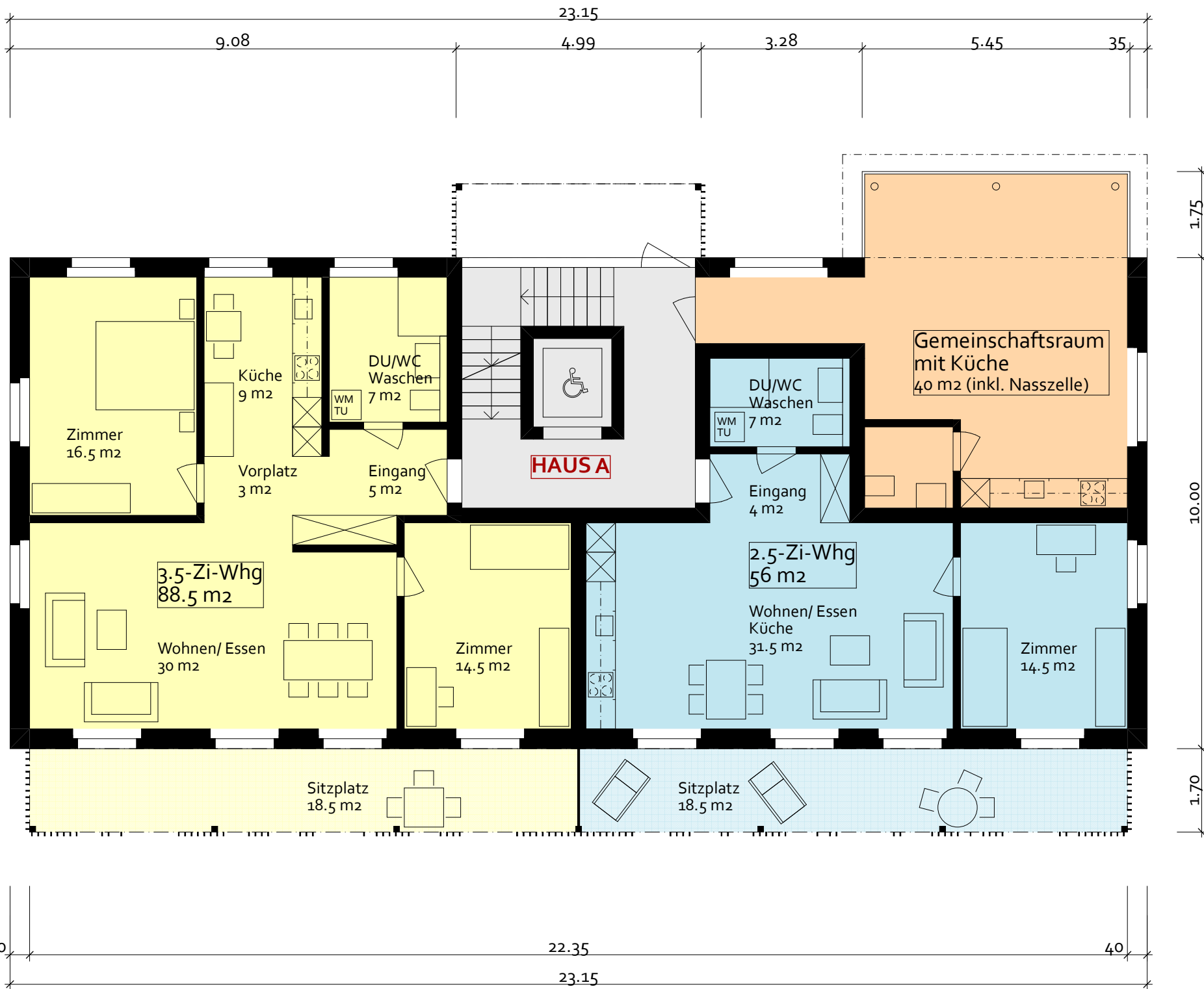
Grundriss Erdgeschoss, Haus A
